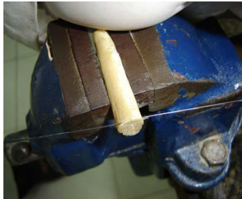
شکل ۱۳. تهیه برش مناسب از باله سینه ای ماهی اسبله Silurus glanis به کمک اره مویی. منبع: رضا نهرور. پژوهشکده آبی پروری
